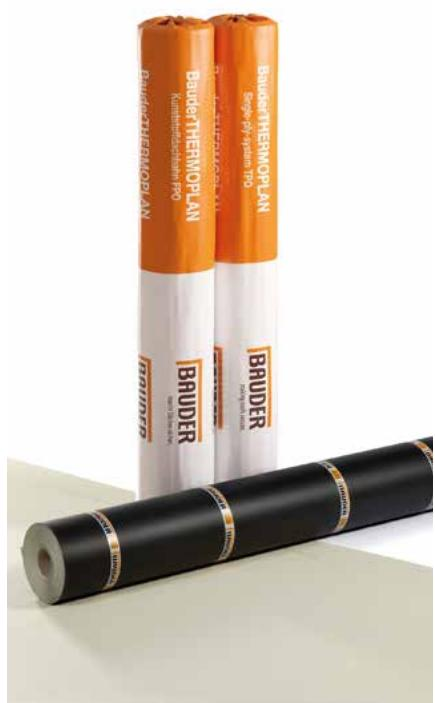
BauderTHERMOPLAN T 15/18/20 so univerzalne folije iz umetne snovi, izdelane v debelinah od 1,5 do 2,0 mm in armirane s sintetično tkanino. To jim zagotavlja dimenzijsko stabilnost, visoko pretržno trdnost kakor tudi uporabo s točno prilagojenim pretržnim raztezkom.
