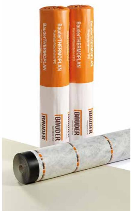
BauderTHERMOPLAN T 15/18/20 V so univerzalne folije iz umetne snovi, izdelane v debelinah od 1,5 do 2,0 mm. Armirane so s sintetično tkanino in dodatno na spodnji strani, kaširane s posebno kopreno. To jim daje poleg zanesljivih lastnosti močnih trakov možnost lepljenja z lepilom PU tako, da so varni pred vrtinci vetra.
