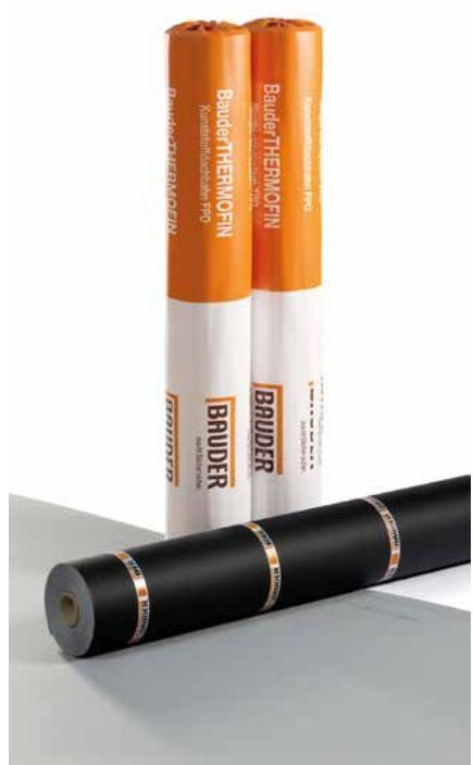
BauderTHERMOFIN F 15/18/20 so univerzalne folije iz umetne snovi, izdelane v debelinah od 1,5 do 2,0 mm in armirane z vložkom iz steklene volne. Ta poseben vložek mu daje visoko mersko stabilnost, visoko raztegljivost in zagotavlja zahtevane protipožarne lastnosti.
